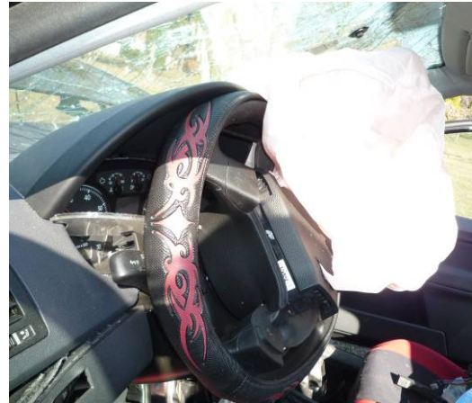
Starke Deformationen am Lenkrad und am Armaturenbrett des VW Polo
