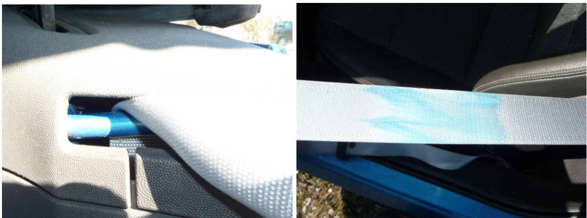
Abbildung 2-11: Obere Gurtumlenkung über lackierten Metallteil (linkes Bild) und großflächige blaue Lackauftragungen am Gurtband (rechtes Bild) (Lichtbild aufgenommen vom SV am ##.##.2011)
